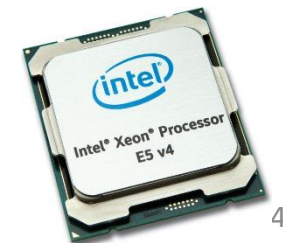
22 Core - Intel® Xeon® Processor E5-4669 v4 ~7.2 bilhões de transistor
